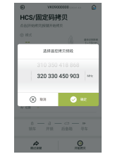
3.1 进入KEY TOOL MAX固定码遥控拷贝界面，选择320.5MHz频率范围
